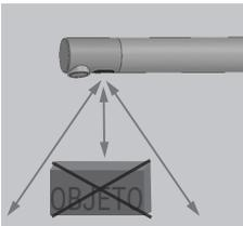
Después el reemplazo de las pilas, alejarse de la detección y esperar 15 segundos el parámetro de la distancia ideal.
