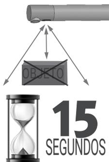
Después el reemplazo de las pilas, alejarse de la detección y esperar 15 segundos el parámetro de la distancia ideal.
