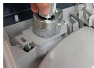
Insertar e inclinar el motor para colocarlo en la placa asiento
