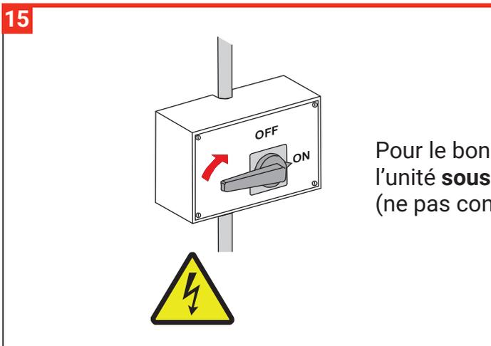
Pour le bon fonctionnement, il est nécessaire de maintenir l'unité **sous tension constante** (ne pas connecter l'alimentation derrière un interrupteur)!
