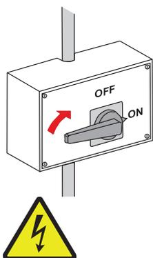
Pour le bon fonctionnement, il est nécessaire de maintenir l'unité sous tension constante (ne pas connecter l'alimentation derrière un interrupteur) !
