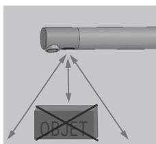
Après avoir remplacé les piles, s'éloigner de la détection, et attendre 15 secondes le paramétrage de la distance idéale.
