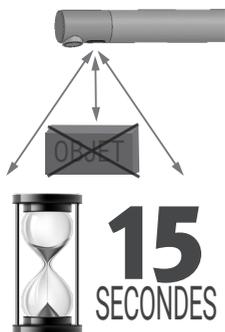
Après avoir remplacé la pile, s'éloigner de la détection, et attendre 15 secondes le paramétrage de la distance idéale.
