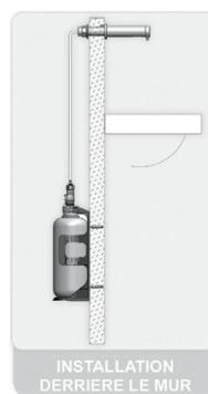
Installation du distributeur de savon derrière le mur, sous le lavabo ou derrière le miroir.
