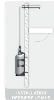
Installation du distributeur de savon derrière le mur, sous le lavabo ou derrière le miroir.
