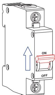
Pour le bon fonctionnement, il est nécessaire de maintenir l'unité **sous tension constante** (ne pas connecter l'alimentation derrière un interrupteur) !
