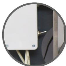
Pour la mise en fonctionnement, mettre l'interrupteur sur la position Marche (= 3 bips) avant de remettre le capot.
